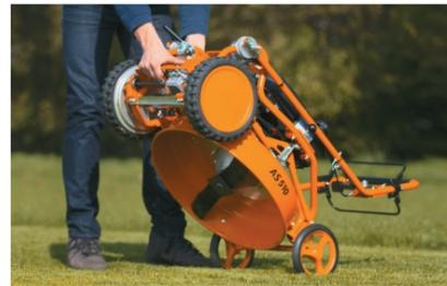
**Schnell klappbarer Holm: bequeme Serviceposition und einfacher Transport, sogar im PKW.**
