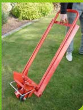
CLIPLIFT se déplace aisément grâce à sa poignée et ses roulettes de grand diamètre.
