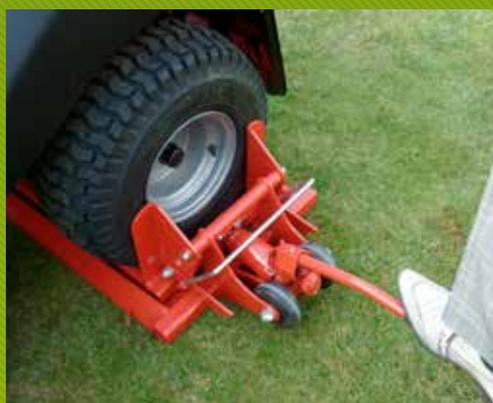
Un **vérin hydraulique** équipé d'une pompe à pied permet le basculement sans effort.
