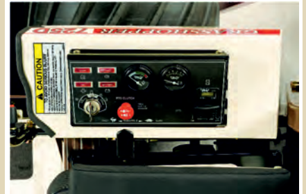
Ohjauspaneeli on sijoitettu kuljettajan oikealle puolelle josta näkee nopeasti mittariston ja varoitusvalot
