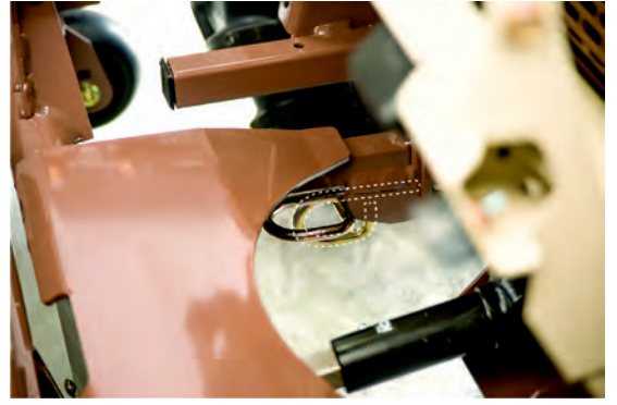
Etuleikkurimallien patentoitu pikakiinnitysjärjestelmä. Työlaitteen vaihto nopeasti ja helposti
