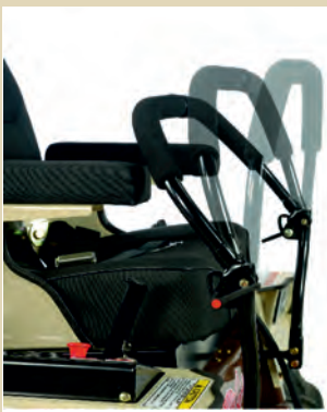
Ajosauvat ovat säädettävissä nopeasti kuljettajan mukaan
